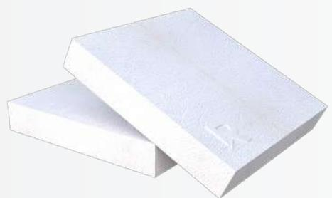
يتم تصنيع عزل البوليسترين الموسع (EPS) من حبيبات صغيرة من البوليسترين، ممزوجة بعامل نفخ البنتان. يؤدي التعرض للحرارة إلى تمدد حبيبات البوليسترين. يتم إنتاج ألواح عزل EPS عن طريق تمدد الحبيبات عن طريق الحرارة داخل القوالب لتحقيق الشكل المطلوب ودمج الحبيبات.
